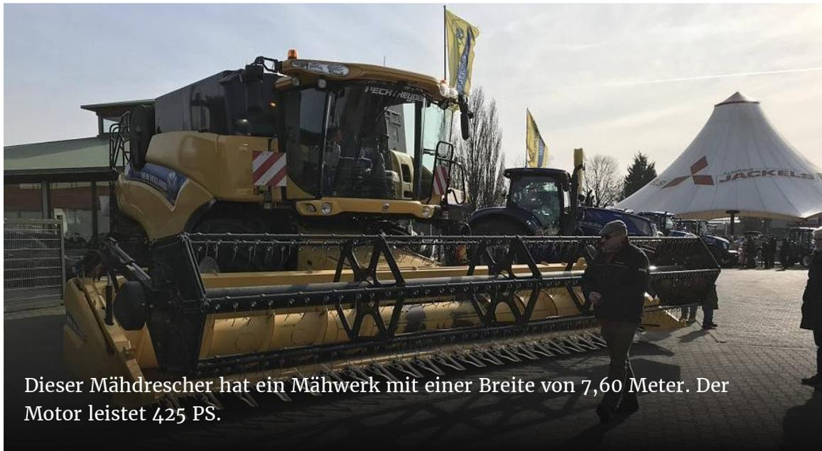
Dieser Mähdrescher hat ein Mähwerk mit einer Breite von 7,60 Meter. Der Motor leistet 425 PS.
